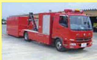
大型除染システム車 Decontamination truck
