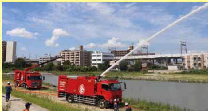
ドラゴンハイパー・コマンドユニット (大容量送水ポンプ車と大型放水砲搭載 ホース延長車) Dragon hyper command unit: with high-volume pumper and hose extension vehicle
