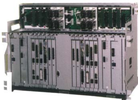
自動列車運転装置
