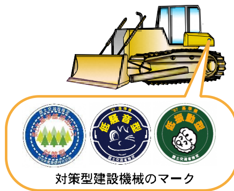
<低騒音型建設機械の採用>
