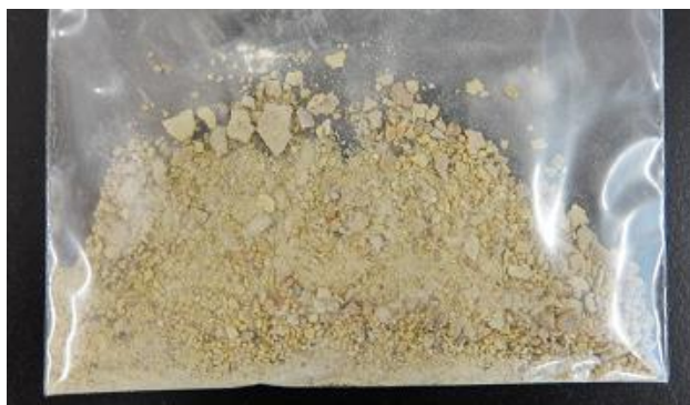
図 1 臨海工場ボイラー水管付着飛灰
