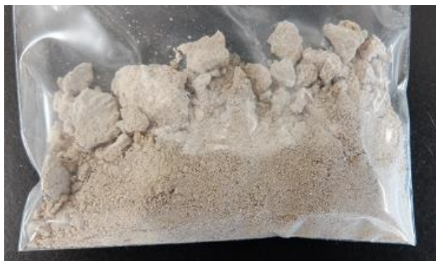
図 2 西部工場ボイラー水管付着飛灰
