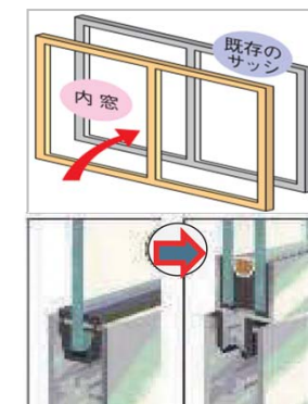
複層ガラス等への改修
