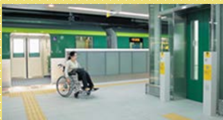
全ての駅で車椅子対応車両のすぐ前にエレベーターが設置されている
