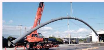
耐震管の吊上げ実験の様子
