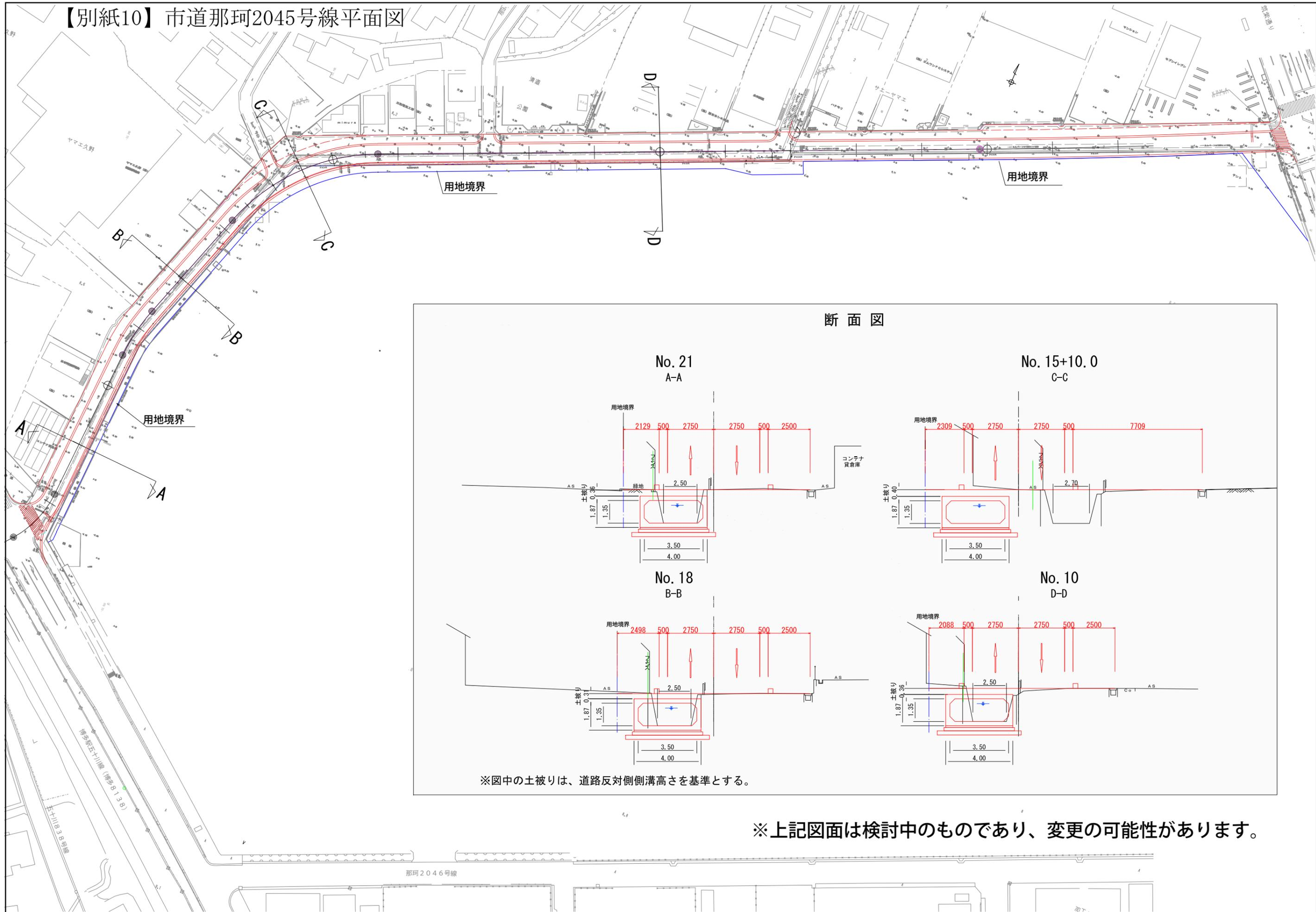
※図中の土被りは、道路反対側側溝高さを基準とする。
