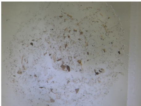
図5 蚊 50 頭のビーズ式破砕機による破砕結果 (CK14 ビーズを使用)
