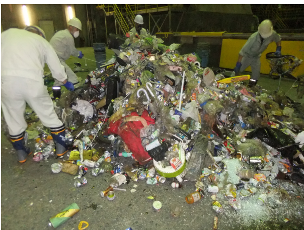
図2 資源化センター減容・減量効果調査作業(搬入ごみ)
