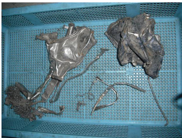
図7 西部の破碎可燃物中に多く見られた「ステンレス系金属」
