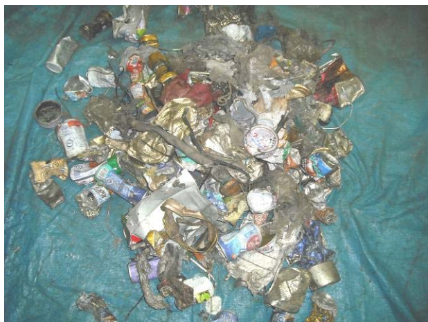
図 14 通常の破砕選別処理工程で回収される「鉄」
