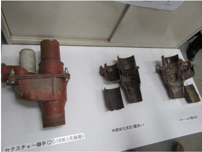
排水管、集合管抜管
