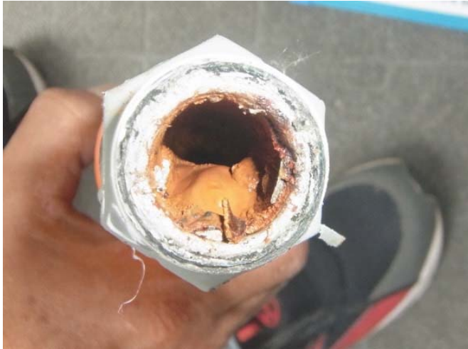
硬質塩化ビニルライニング鋼管: 内部錆瘤、錆の被膜
