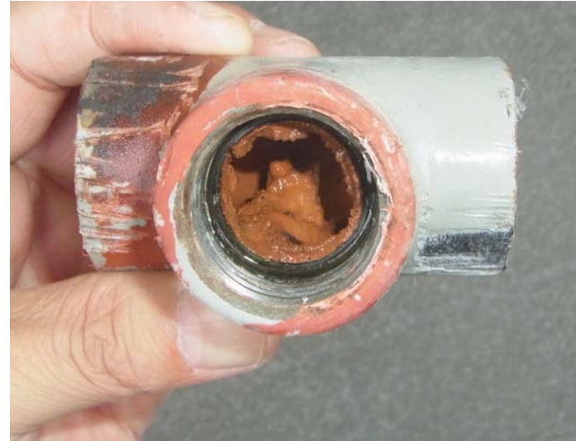
硬質塩化ビニルライニング鋼管: 内部錆瘤、錆の被膜
