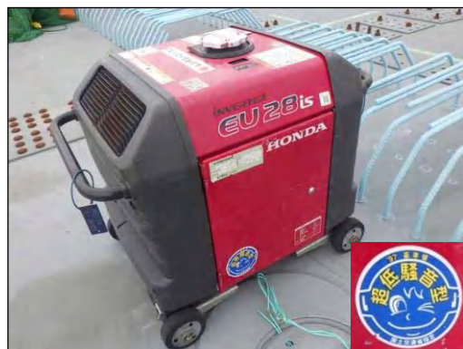
写真④-5 低騒音型建設機械の使用状況 2
