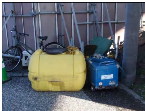
写真①-6 工事用車両のタイヤ洗浄設備
