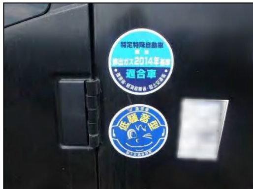
写真②-3 低騒音型建設機械の採用
