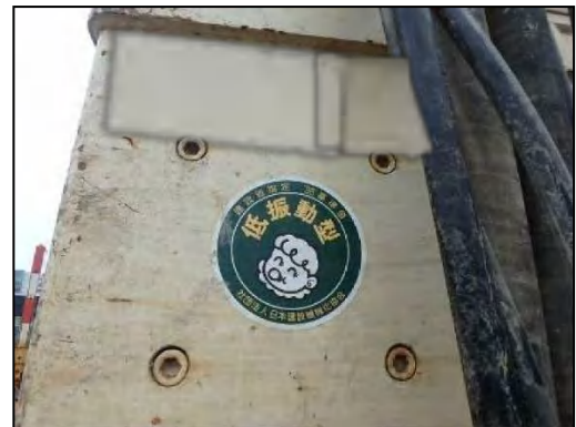
写真②-4 低振動型建設機械の採用
