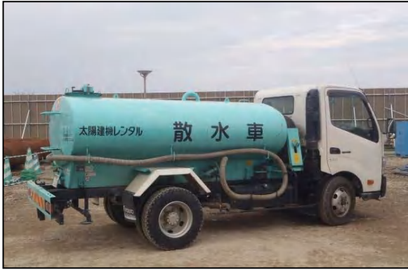
写真②-1 施工ヤードへの散水設備
