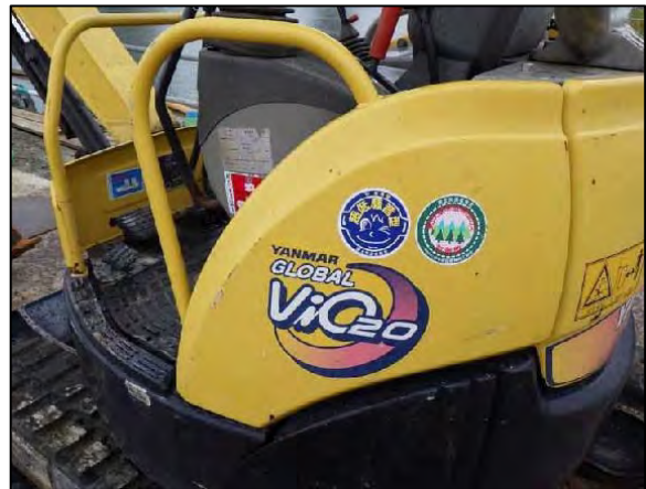
写真④-4 低騒音型建設機械の使用状況
