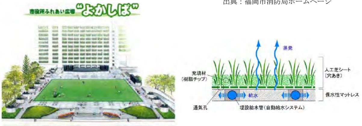
特長 芝面下層部の保水性マットレスへの自動給水システムと、保水性マットレスからの水分蒸発による気化熱効果を利用し、地表面温度を下げる仕組みとなっています。
