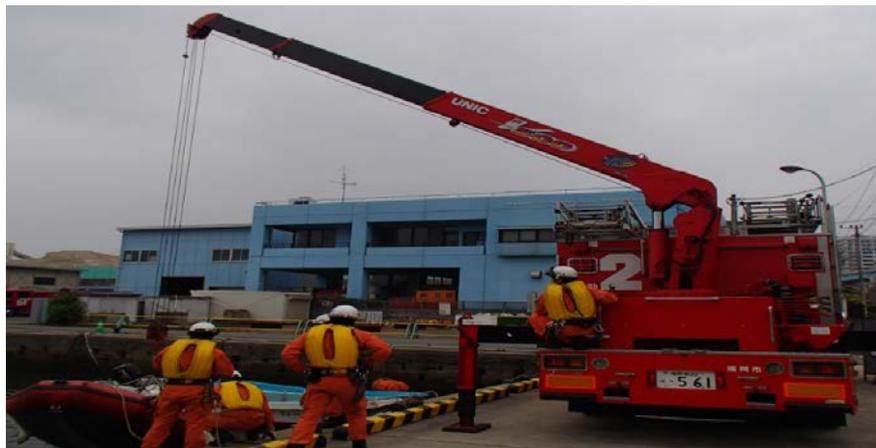
(クレーン装置 最大吊上能力 2.9トン以上)
