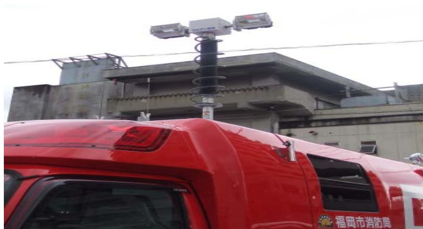
(固定照明装置 マスト付LED照明灯 160ワット×4灯式)
