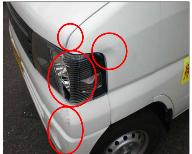
④破損状況 左前部
