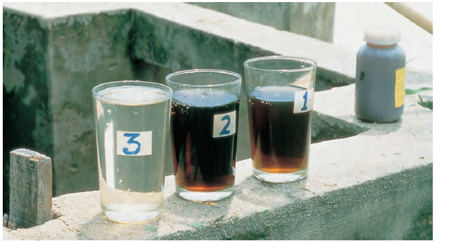
浸出水(1:原水、2:曝気後、3:ろ過・吸着処理後)
