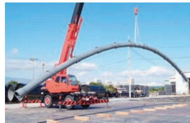
ダクタイル鋳鉄管(耐震管)の吊上げ実験の様子 写真提供：一般社団法人日本ダクタイル鉄管協会
