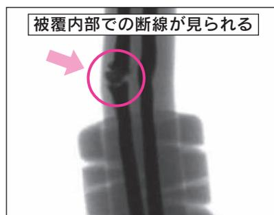
被覆内部での断線が見られる
