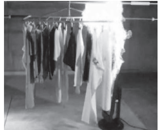
【nite再現実験】電気ストーブに洗濯物が接触後2分45秒で発火
