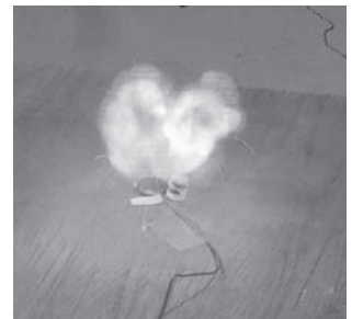
【出典：nite再現実験より】 アルカリ乾電池とボタン電池の電極が接触しショートして発火した時の様子
