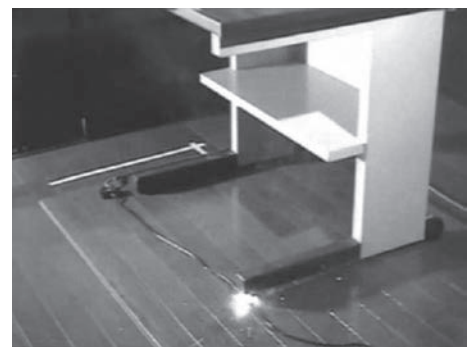
【出典：nite再現実験より】 踏みつけられたコードが断線し発火する様子
