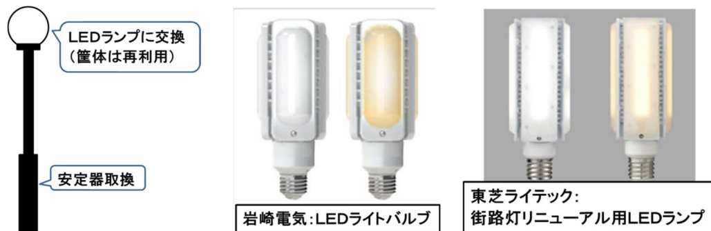
図6. LED ランプ方式, LED ランプ例
