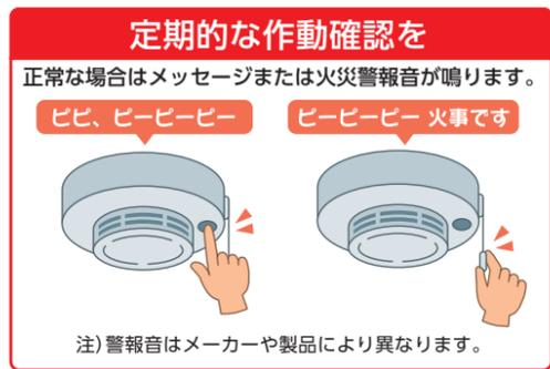
**■火災警報器** 警報器は、ひもを引くか、ボタンを押して定期的に作動確認を行ってください。左イラスト。寿命により火災を感知できなくなる恐れがあるので、電池交換だけでなく10年を目安に機器本体を取り換えてください。
