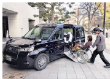
車いす用のスロープが付き、乗降口や車内が広い、誰もが利用しやすいUDタクシー(会場で展示)
