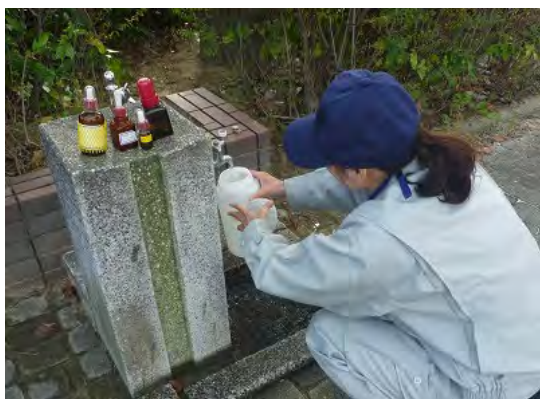
給水栓の採水
