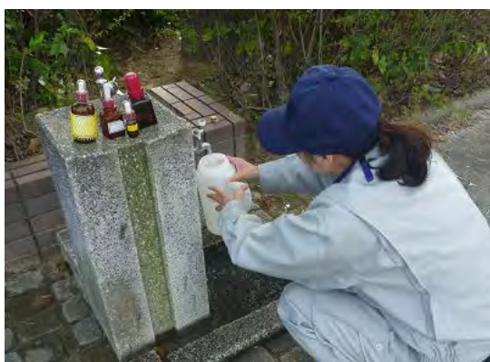
給水栓の採水
