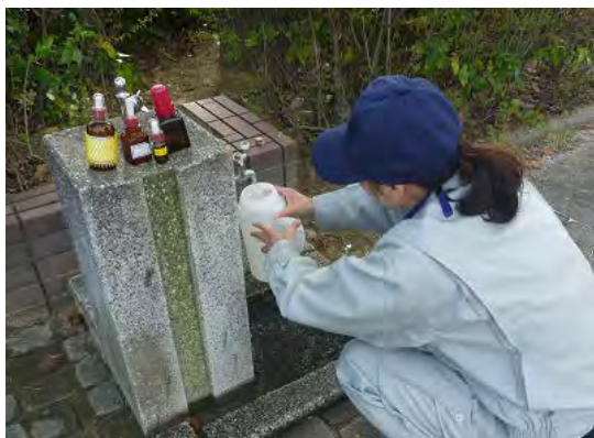
給水栓の採水
