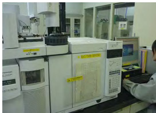
給水栓の消毒副生成物検査
