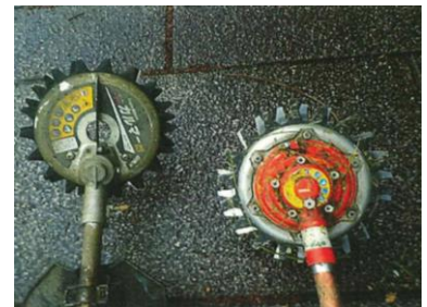
飛び石しにくい機械 (カルマー、無双ツインブレード)
