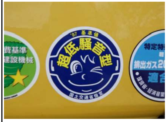
騒音対策（超低騒音型重機の使用）
