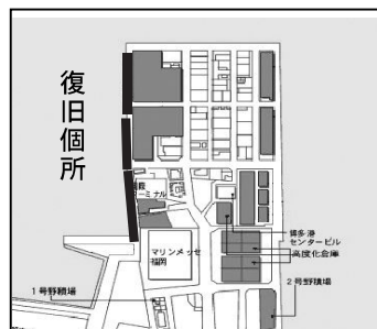
岸壁（水深10m×延長590m）
