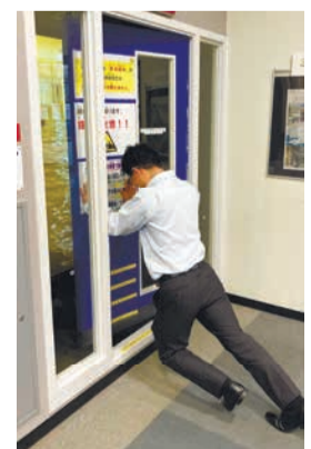
水深10〜40センチ(大人のくるぶしから膝上程度の水圧)の力を体感
