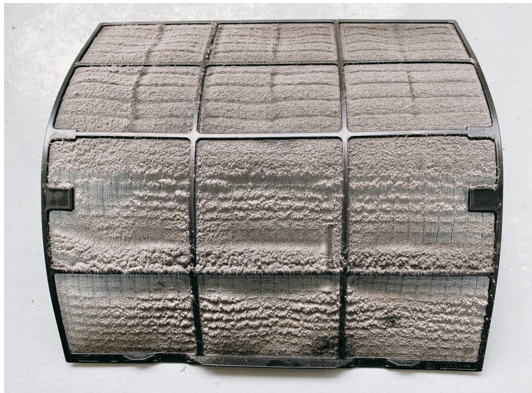
ほこりで目詰まりしたフィルター
