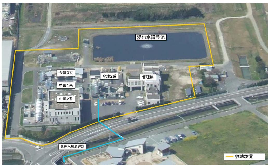
西部污水处理場では、西部(中田)埋立場とすでに埋め立てが完了している今津埋立場で発生する浸出水を集めて処理しています。
