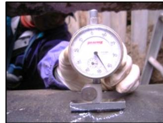
管外面の腐食深さを計測
