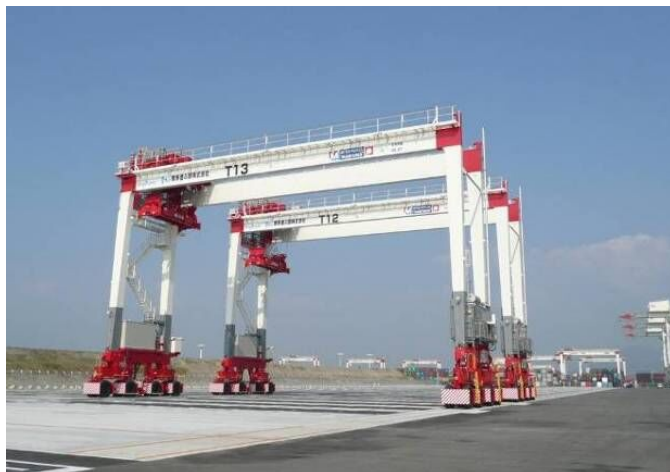
<C2コンテナターミナルに導入したハイブリッド型トランスファークレーン *3 >
