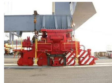
<クレーンの免震装置>
