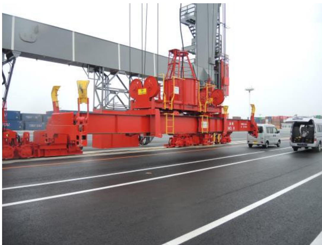
スプレッダーはコンテナの大きさに合わせて調整できます
