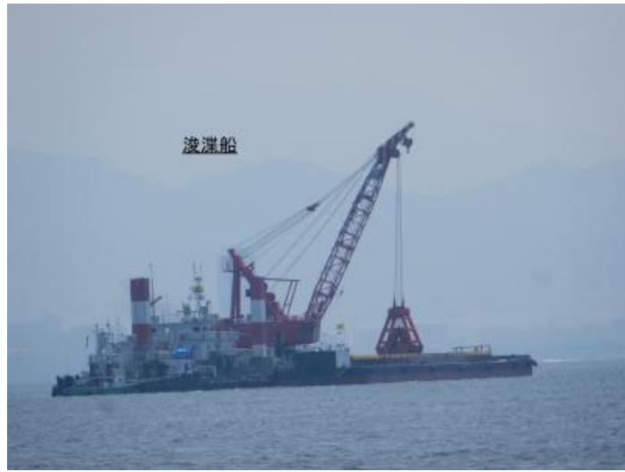
↑しゅんせつ船が海底の土を掘り、航路をつくっていきます。
