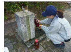
給水栓での採水
