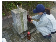
給水栓での採水
