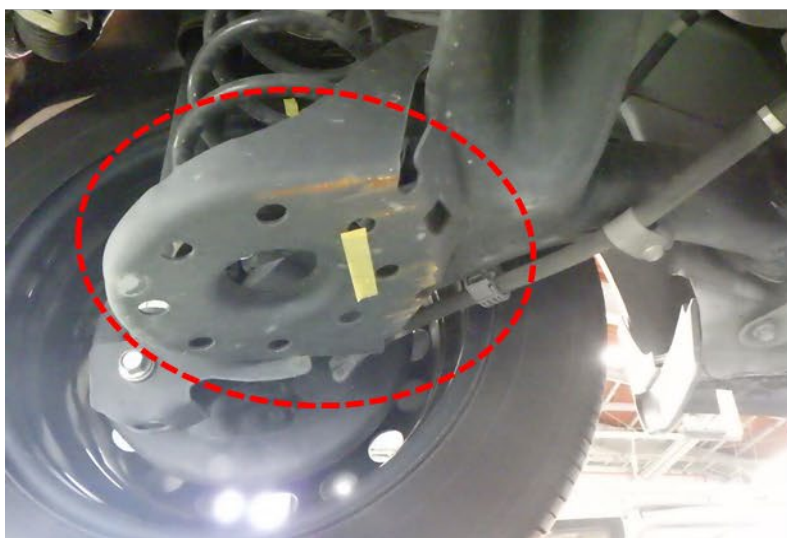
左後輪サスペンション装置 ※黄色テープは破損箇所のマーキング
