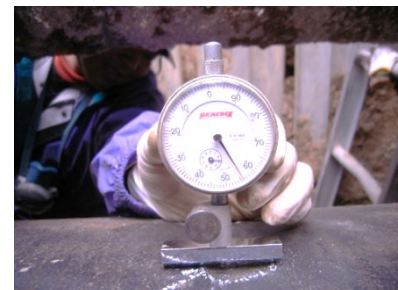
管外面の腐食深さを計測
