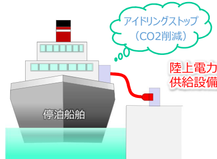
船舶への陸上電力供給
