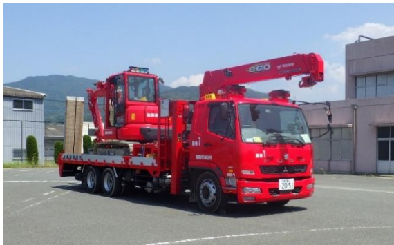
重機及び重機搬送車
