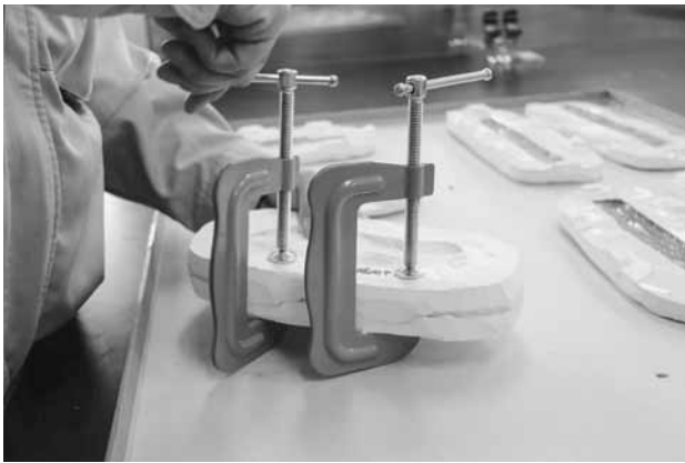
写真 11 型を合わせクランプで固定 (工程③)
