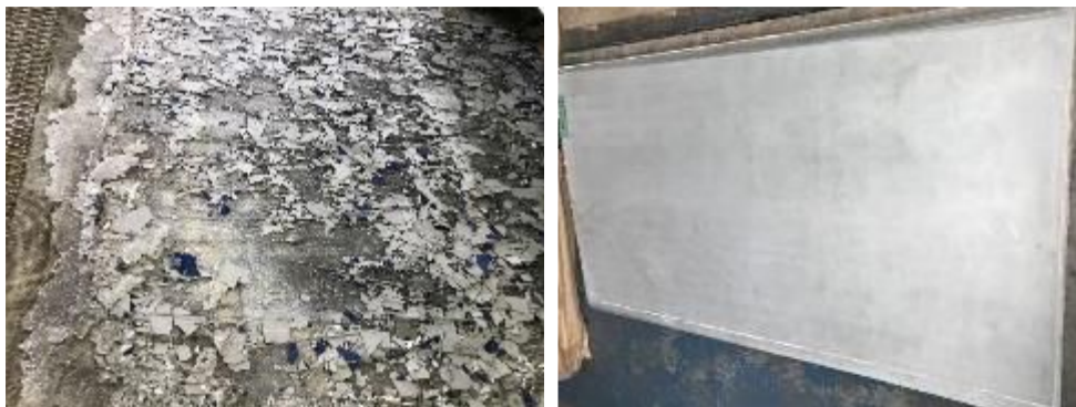
図表 43 熱分解後のパネル外観
