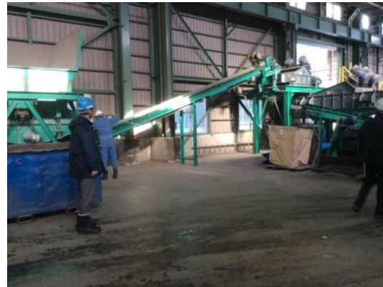
図表 34 破碎後ホッパーへの投入
