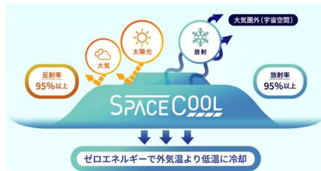
太陽光の**反射**と赤外線**放射**を高効率で両立したゼロエネルギーの冷却素材
