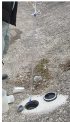
ベアラー採水器の例（左：採水状況、右：採水器本体）
