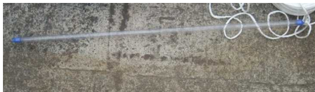
ベアラー採水器の例（左：採水状況、右：採水器本体）
