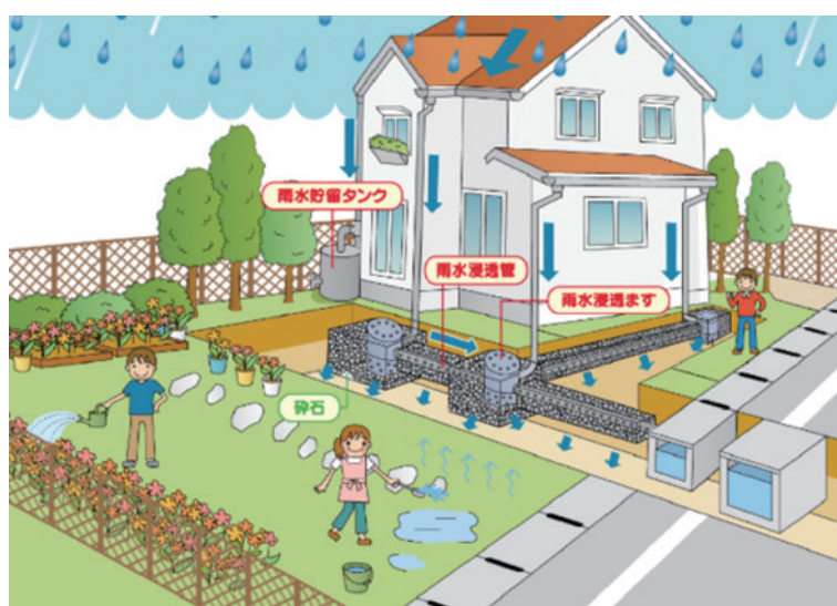
図 3-3 雨水流出抑制施設のイメージ
